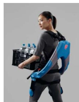
※人工筋肉をアクチュエーターとした外骨格型アシストスーツシリーズ累計出荷台数。2020年12月末時点。
