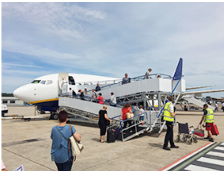
スイッチバック方式の乗降装置 (バリアフリー対応を含む)
