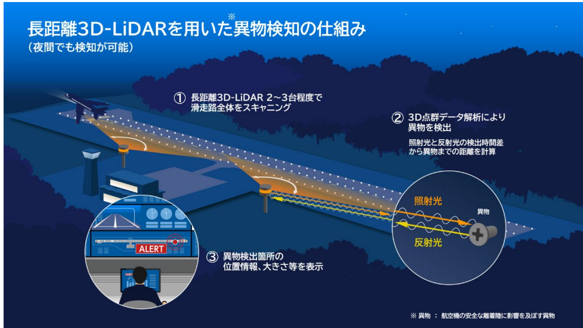
長距離 3D-LiDAR を活用した異物検知システムの概要
